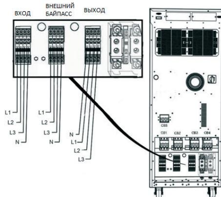
Все электрические подключения кабелей производятся в задней части ИБП. Клеммы подключения находятся под крышкой в нижней части ИБП:
