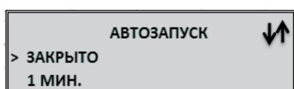
ния. Для автоматического запуска ИБП и подачи питания на нагрузку после восстановления параметров входного питания используется пункт меню Авторестарт. Используя пункт ON/OFF включите/отключите автоматический запуск и используя расположенный ниже пункт продолжительности определите, через какой промежуток времени ИБП включит питание на нагрузку.
