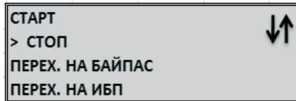
3. Убедитесь в переходе ИБП в режим байпаса. Индикатор байпаса на панели мнемосхемы.
