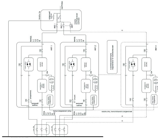
При параллельной работе, входы ИБП питаются с общего ввода, а выходы каждого ИБП объединены на общем выходе пофазно. При этом каждый ИБП имеет свой собственный массив аккумуляторов. Один аккумуляторный массив не может использоваться несколькими ИБП одновременно.
