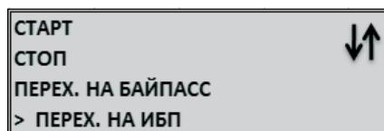
5. Индикаторы на передней панели и ЖК экран должны показать, что ИБП включил выпрямитель, затем включил статический (электронный) байпас, а затем перешел на работу от инвертора, в нормальный режим работы.
